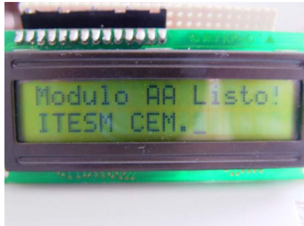
Figura 8.39 - El módulo de LCD resultó un éxito, ya que se tecleo en la computadora el texto que aparece en el display. El texto fue apareciendo sin retraso alguno al ojo humano.
