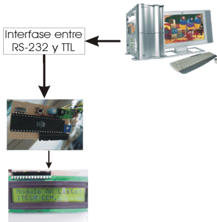
Figura 8.34 - Esquema general de conexión para desplegar la información transmitida del puerto serial de la computadora a un display de LCD.
