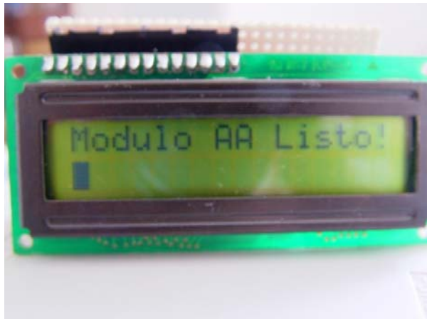
Figura 8.38 - Mensaje de inicio del módulo de display. Muestra la dirección del módulo y el estado del módulo. También deja el cursor parpadeando en espera de recibir información a desplegar.
