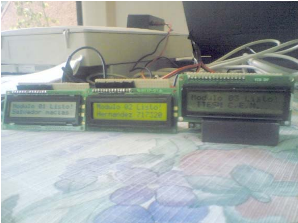
Figura 8.45 - Fotografía que muestra el resultado satisfactorio del experimento que demuestra que es viable el hacer que varios microcontroladores trabajen colaborativamente en la línea transportadora inteligente. También demuestra que no es necesaria una computadora central que coordine absolutamente todo. En este experimento se tecleó mi nombre, matrícula y escuela donde estudio. Y lo cual fue desplegado en tiempo real y en los tres displays que se muestran.
