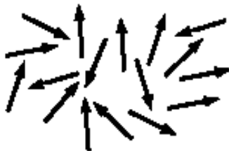
Figura 2.11 - Momentos magnéticos orientados al azar.
