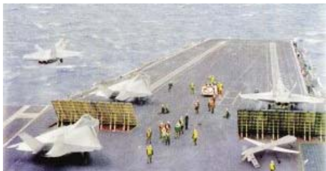
Figura 4.63 - Los sistemas EMALS utilizan motores lineales para impulsar a las aeronaves por la borda del portaaviones
