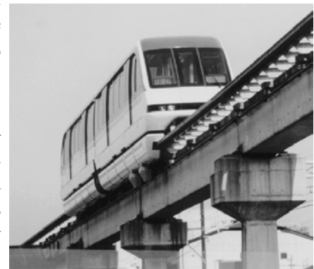
Figura 4.56 - Tren HSST-100L en prueba de vía elevada en la ciudad de Nagoya
