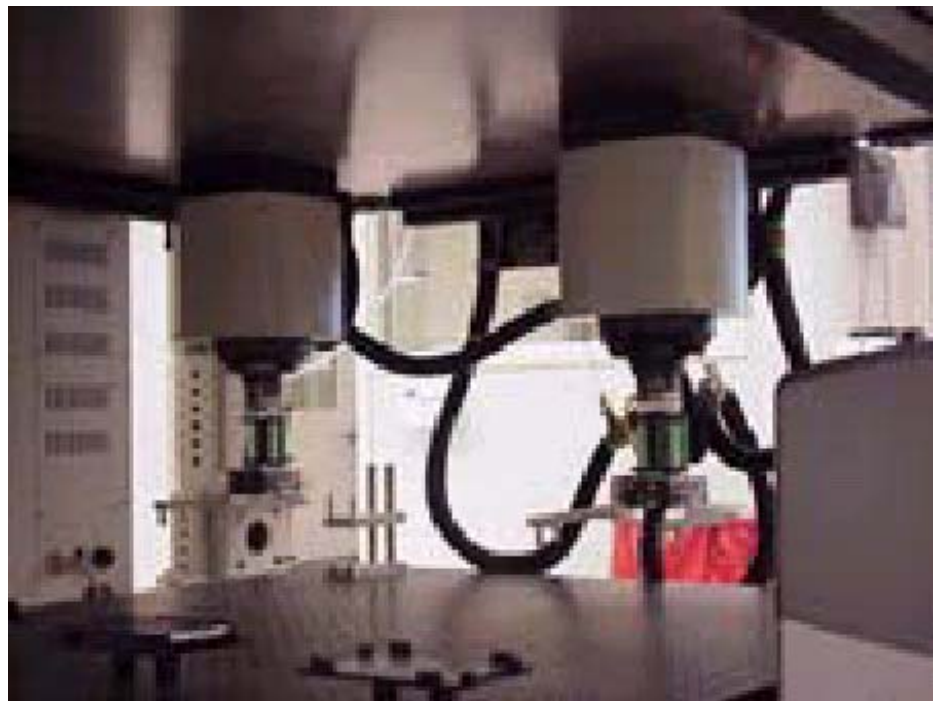
Figura 4.61 - Robot Megamation, diseñado para la industria farmacéutica y realiza un proceso de HTS, utiliza dos motores lineales bidimensionales para posicionar las cepas y el otro para posicionar los instrumentos
