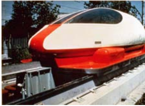
Figura 4.49- Fotografía de un transporte terrestre de alta velocidad que utiliza un motor síncrono lineal
