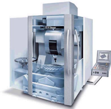
Figura 4.60 - Un centro de maquinado que utiliza 5 motores lineales
