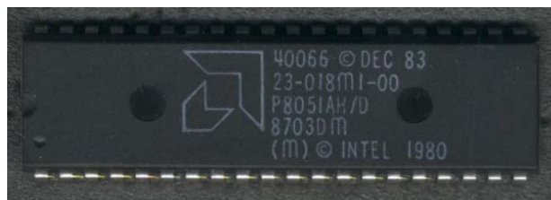
Figura 5.5 - Fotografía de uno de los primeros circuitos integrados 8051, fabricado por Intel.
